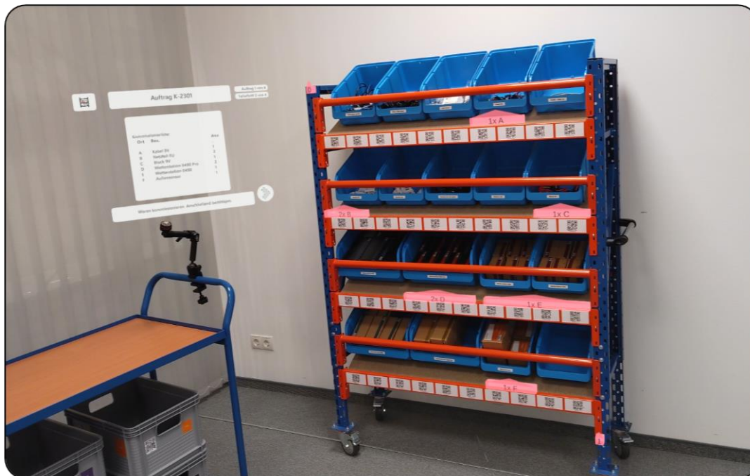
Abbildung 18: Einblendung der relevanten Regalfächer für die Kommissionierung in AR bei der Datenbrille
