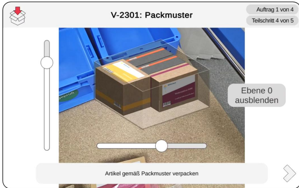
Abbildung 21: Einblendung der Packstruktur als Unterstützung für den Verpackungsschritt als nicht-verankerte Platzierung mit Schiebereglern für die Rotation beim Tablet (Variante 1)
