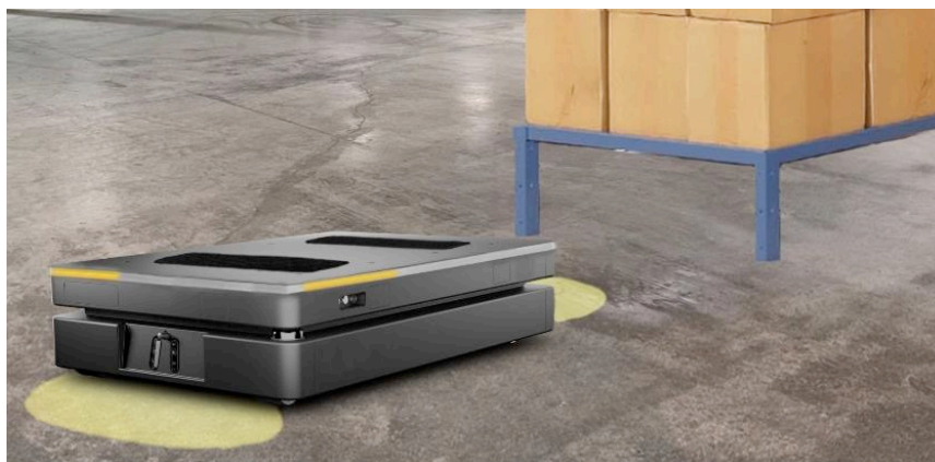
Abbildung 31: Visualisierung zur Intention 10 " Achtung! Ich kann dich nicht sehen. Sei vorsichtig um mich herum.", die gelben Streifen auf dem LED-Band rotieren um den AMR
