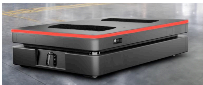
Abbildung 29: Visualisierung zur Intention 8 "Ich habe ein Problem, bitte hilf mir!", das LED-Band pulsiert rot
