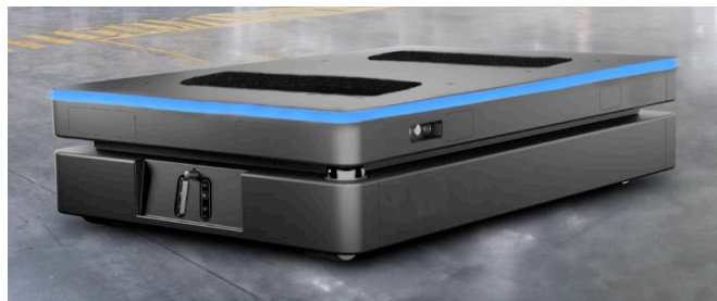
Abbildung 28: Visualisierung zur Intention 7 "Ich warte auf deinen Input.", das LED-Band pulsiert blau
