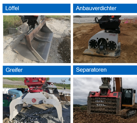
Bild 18: Einsatzvergleiche bei Löffel , Anbauverdichter, Greifer und Separator (Quelle: Lehrstuhl fml)
