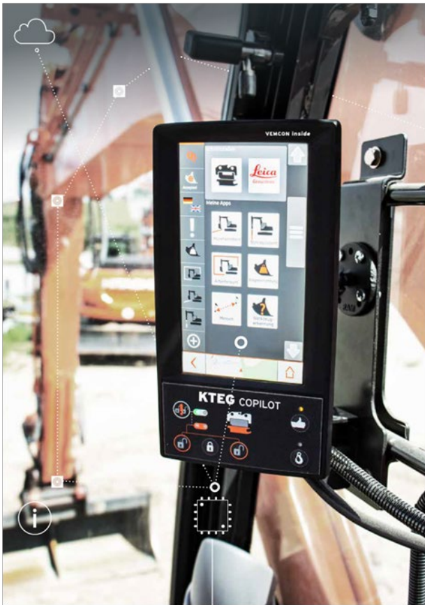
Bild 25: Vemcon CoPilot – CPX Terminal mit intuitiver Touchscreen Steuerung (Quelle: Vemcon)
